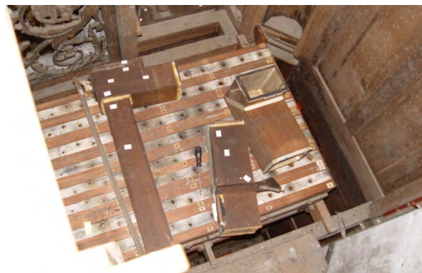
De windlade rechterdeel pedaal en onderdelen windvoorziening, vrijdag 27 augustus 2004
