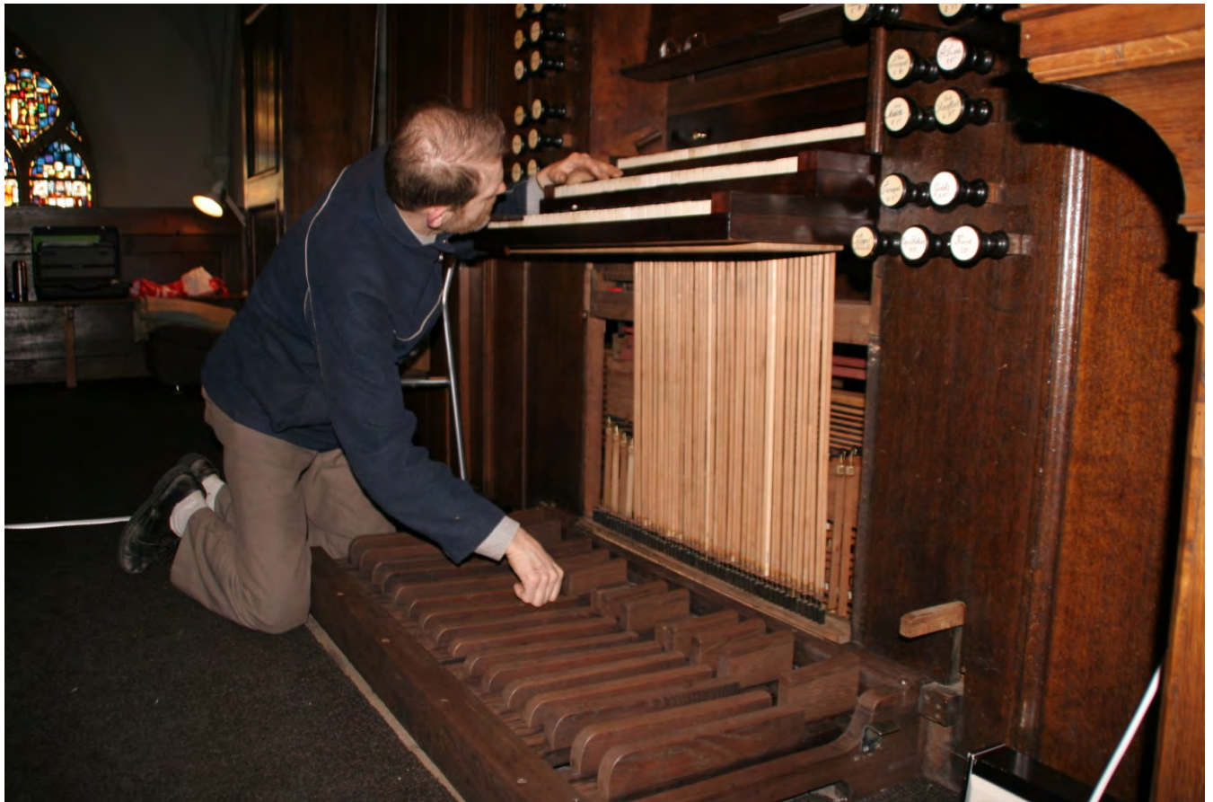
Verschueren-medewerker controleert de afstelling van het pedaal. Rechts onder, naast pedaal en iets hoger, is uit kas stekend hefboom (lichtere kleur hout) van zwelkast te zien. Dinsdag 21 maart 2006.
