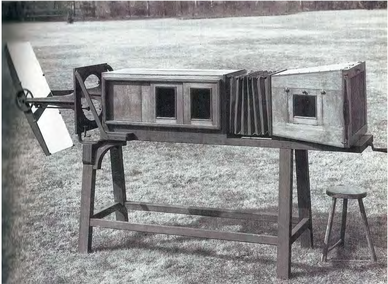
De dialytische daglichtversterker van Van Monckhoven uit ca. 1864.
